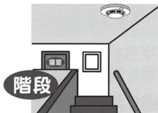
寝室がある階の階段最上部
